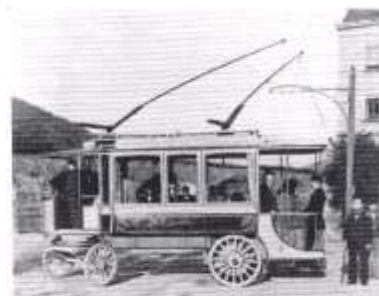
15 Werbung für die „Bielatal“; hier Wagen Nr. 2 beim Wenden mit eigener Kraft, möglich durch die vorst. angeordneten Stromabnehmerstangen; im Hintergrund das Eisenbahnviadukt in Königstein an der Sacke Dresden - Prag.
